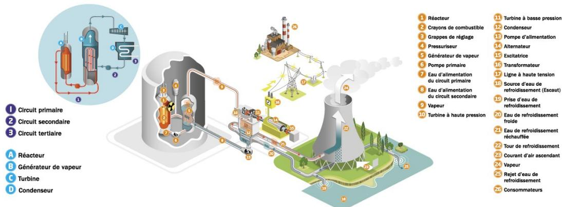
Figure 8 : Fonctionnement schématisé d'une centrale nucléaire
