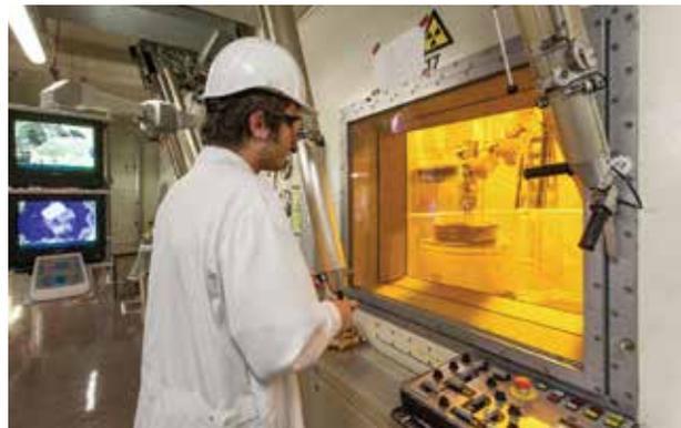
Le tri des déchets est réalisé dans les cellules blindées de Belgoproprocess par du personnel expérimenté.
