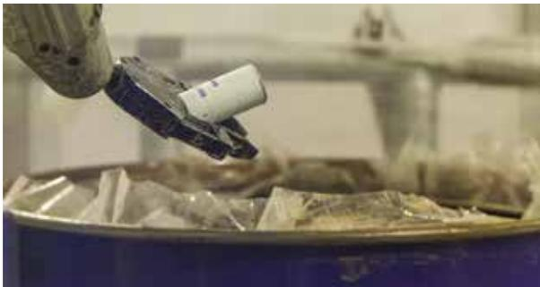
Manipulation de déchets radioactifs à l'aide de télémanipulateurs.
