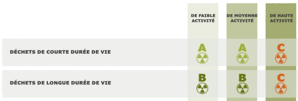
Figure 1 – Représentation simplifiée de la classification des déchets radioactifs. Les déchets de catégorie C émettent une quantité de chaleur non négligeable.
