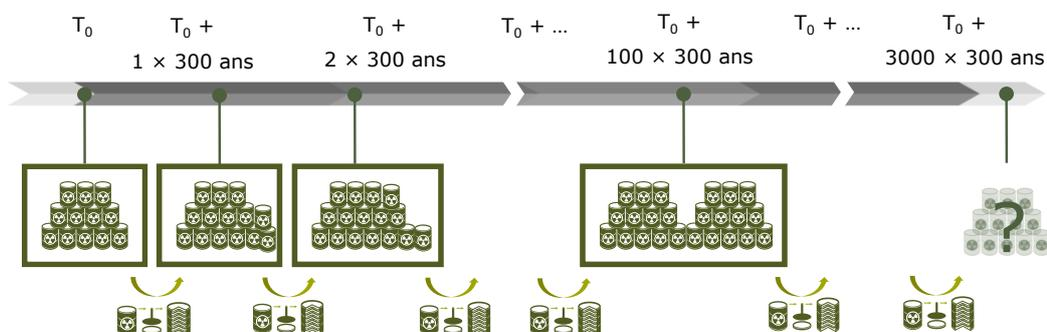
**Figure 11** – Schéma temporel simplifié de la mise en œuvre de l'entreposage perpétuel. La séquence construction-exploitation-déclassement, combinée aux opérations de réemballage/reconditionnement des déchets, est supposée se répéter sur des centaines de milliers d'années, voire pendant une période de l'ordre du million d'années.
