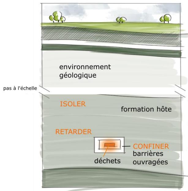
**Figure 6** – Représentation du concept multibarrière dans le cas du stockage géologique. Un système de stockage géologique confine et isole les radionucléides et les contaminants chimiques de la biosphère et retarde leur migration vers celle-ci.
