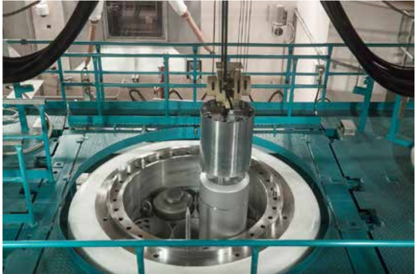
Afin de transporter les déchets radioactifs en toute sécurité, les conteneurs de déchets sont placés dans un emballage de transport spécial. Avant d'être renvoyés en Belgique, les déchets sont minutieusement contrôlés.
