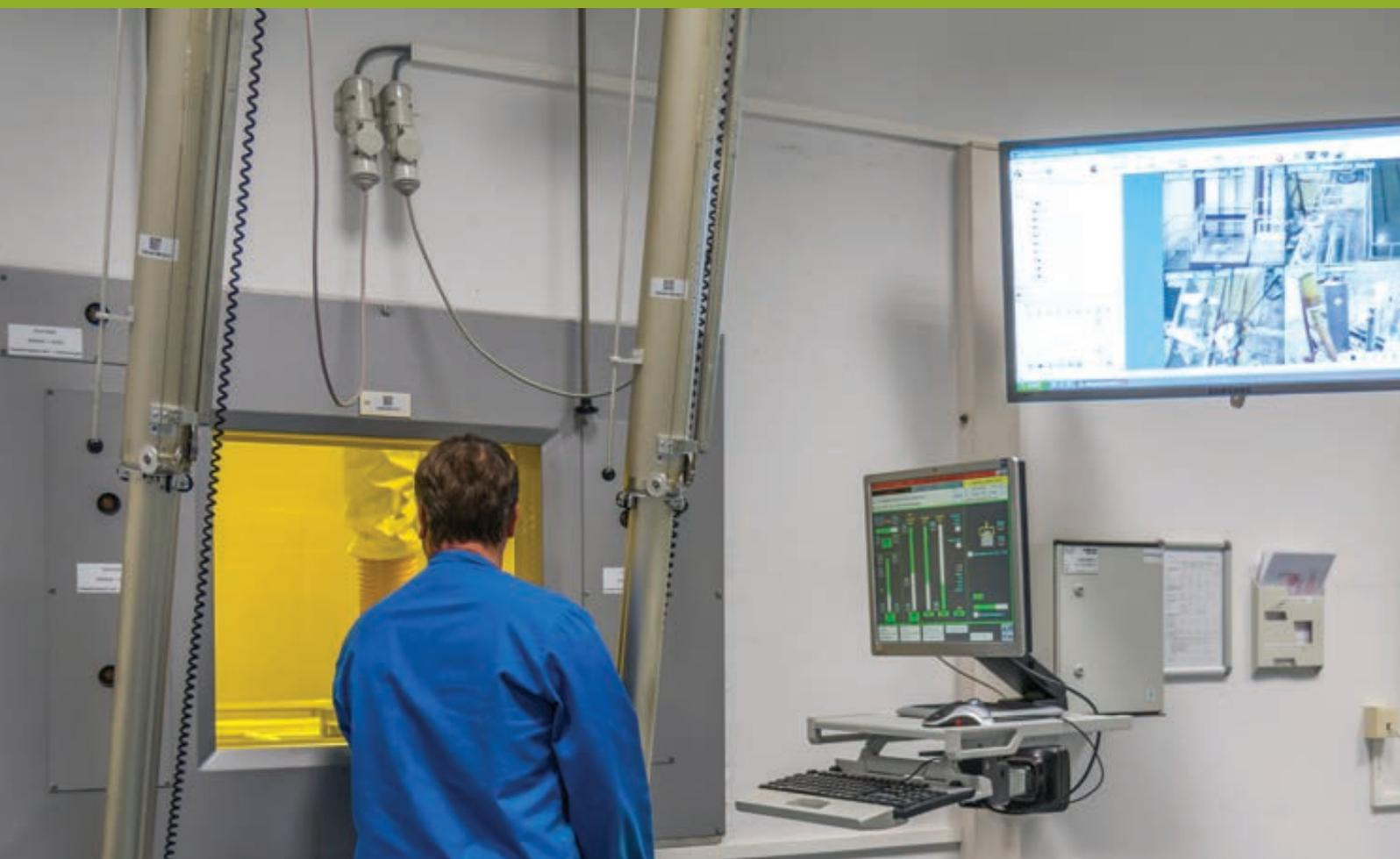
*Les opérateurs de Belgoprocess inspectent les déchets derrière une fenêtre de verre au plomb de 1,2 mètre d'épaisseur.*
