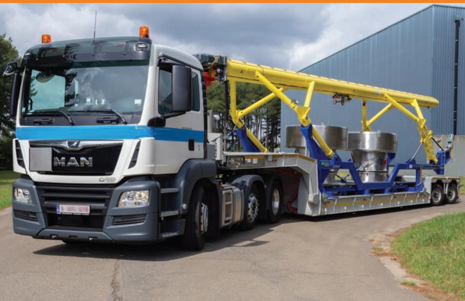
*Le nouveau véhicule de transport lors des tests « à froid » chez Belgoprocess à Dessel. Un auvent protégera les deux emballages de transport de la pluie et du vent.*
