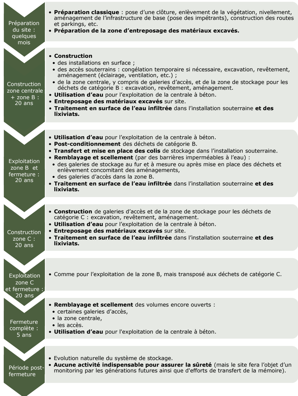
Figure 16 – Aperçu des principales activités considérées durant les différentes phases de la mise en œuvre d'une installation de stockage géologique en galeries jusqu'à sa fermeture complète ainsi que de sa période post-fermeture, durant laquelle aucune activité n'est indispensable pour assurer la sûreté. La restitution du site à un état moins ou non bâti en surface n'est pas considérée dans le SEA (section 6.1.2.1). Les transports, qui constituent une activité transversale à toutes les phases d'activités, ne sont pas représentés.
