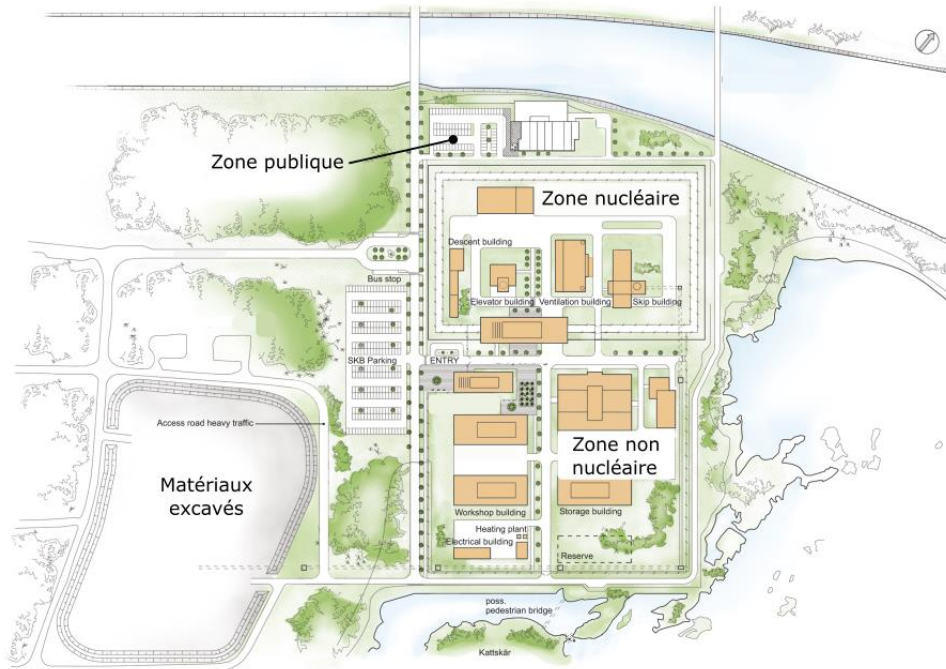
Figure 14 – Schéma d'implantation possible des installations en surface du concept suédois de stockage géologique du combustible usé en galeries [SKB 2011].
