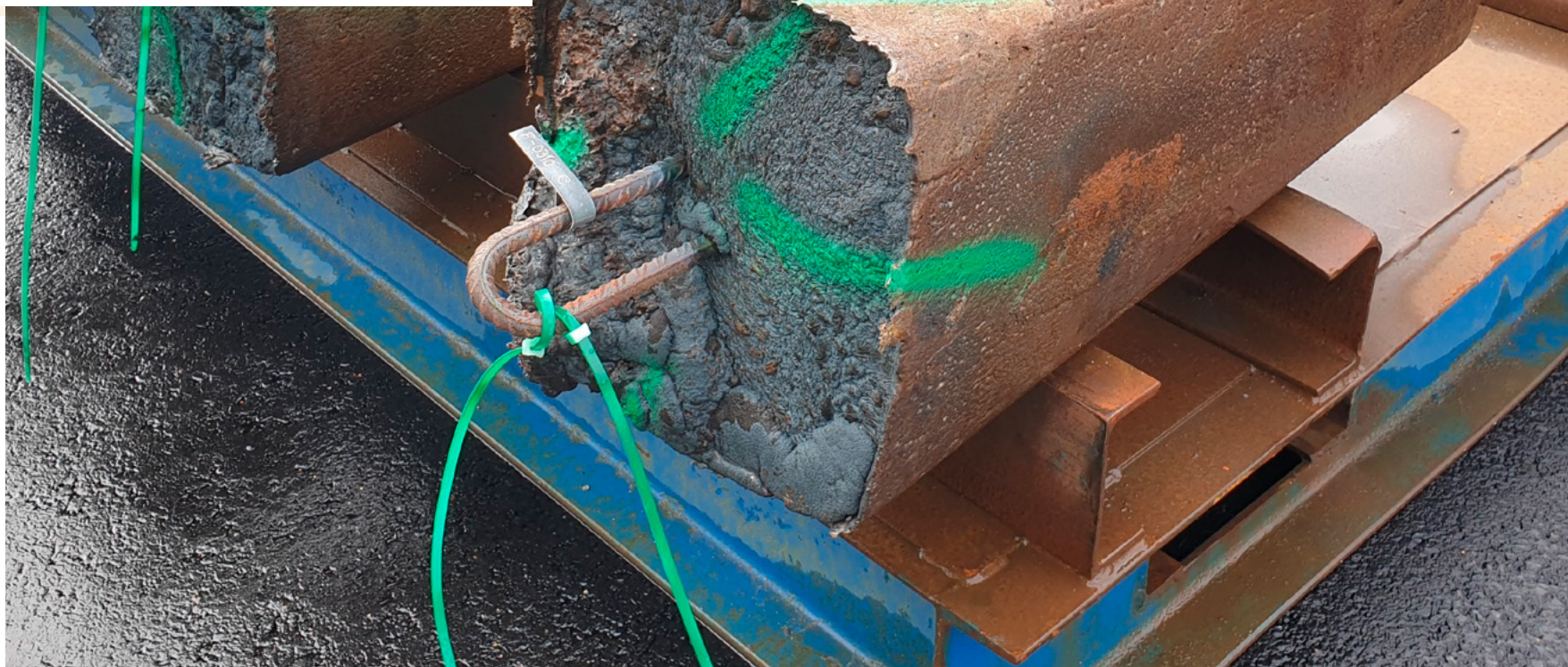
Lingots de scories issues de la fusion de déchets métalliques. © Cyclife Sweden.
