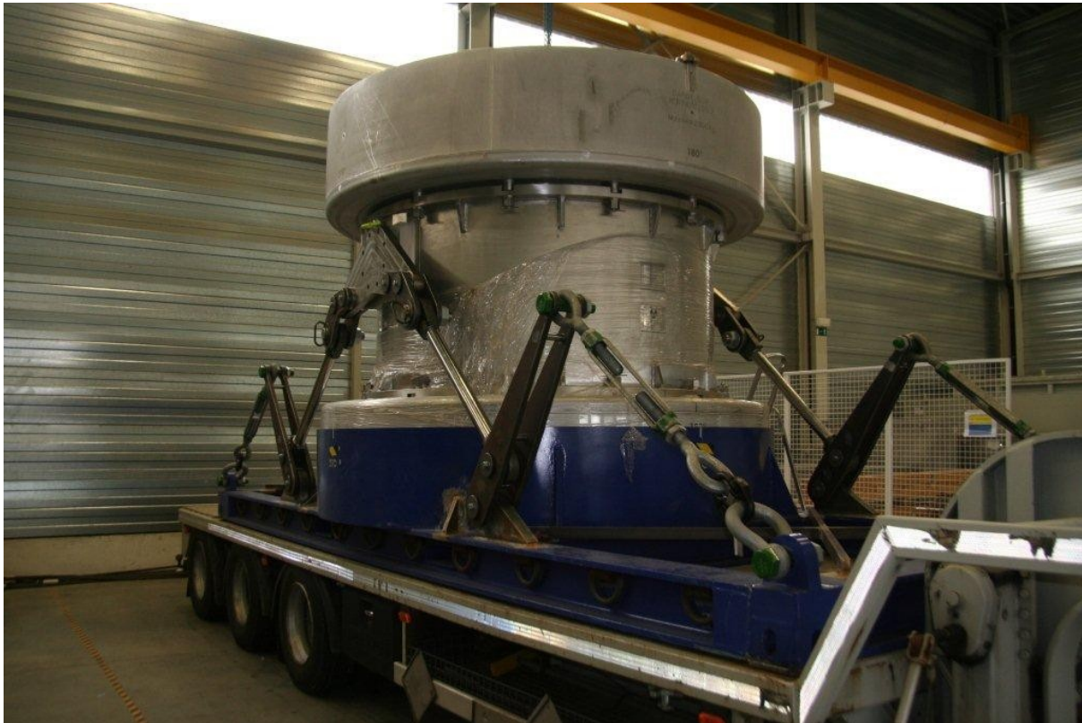
De R74-container op zijn chassis bij de opleveringstesten
