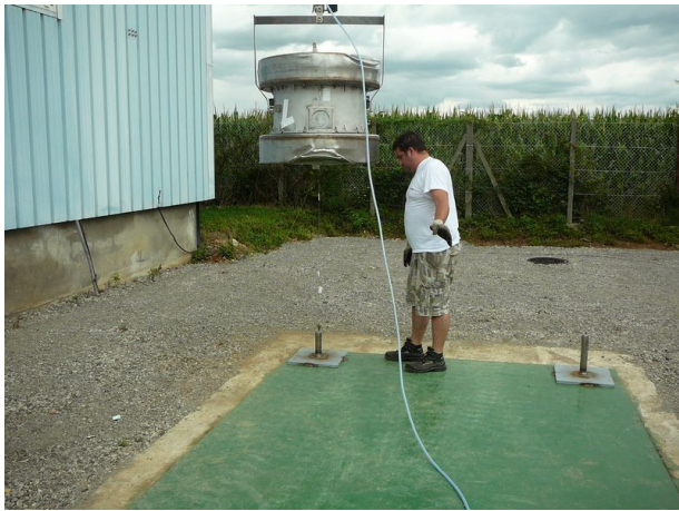
Een val van één meter op een stalen punt (verticaal)
