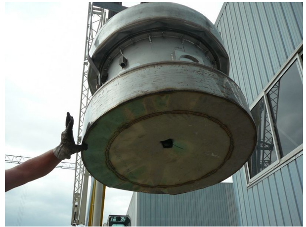
Een val van één meter op een stalen punt (verticaal)
