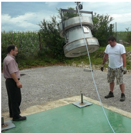
Een val van één meter op een stalen punt (schuin)
