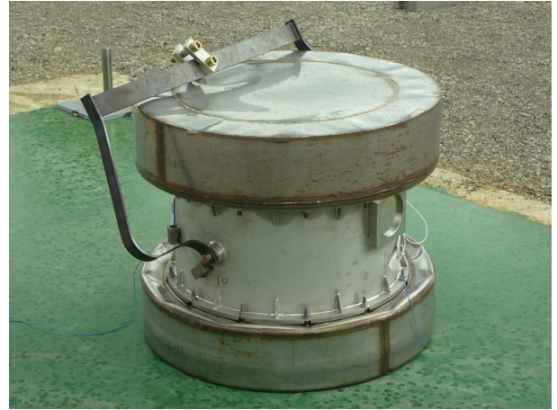
Een vrije val van negen meter op een onvervormbaar oppervlak
