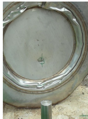
Een val van één meter op een stalen punt (schuin)
