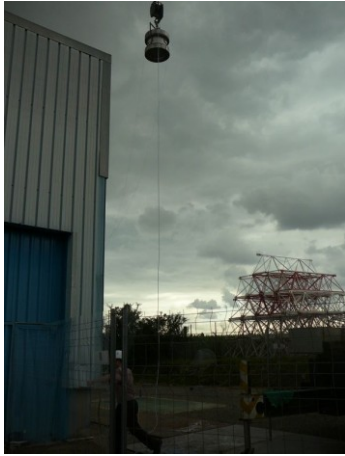
Een vrije val van negen meter op een onvervormbaar oppervlak
