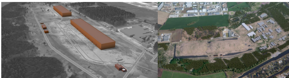
Figuur 1-9: Schematisch overzicht van de bergingsinrichting tijdens exploitatie (links) en na het plaatsen van de afdekking (rechts).
