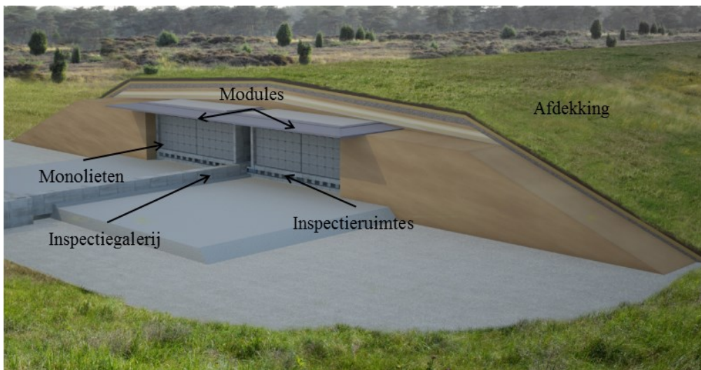
Figuur 1-8: Schets van de bergingsinstallatie na exploitatiefase Ib, wanneer het stalen dak ontmanteld is en vervangen is door een afdekking.
