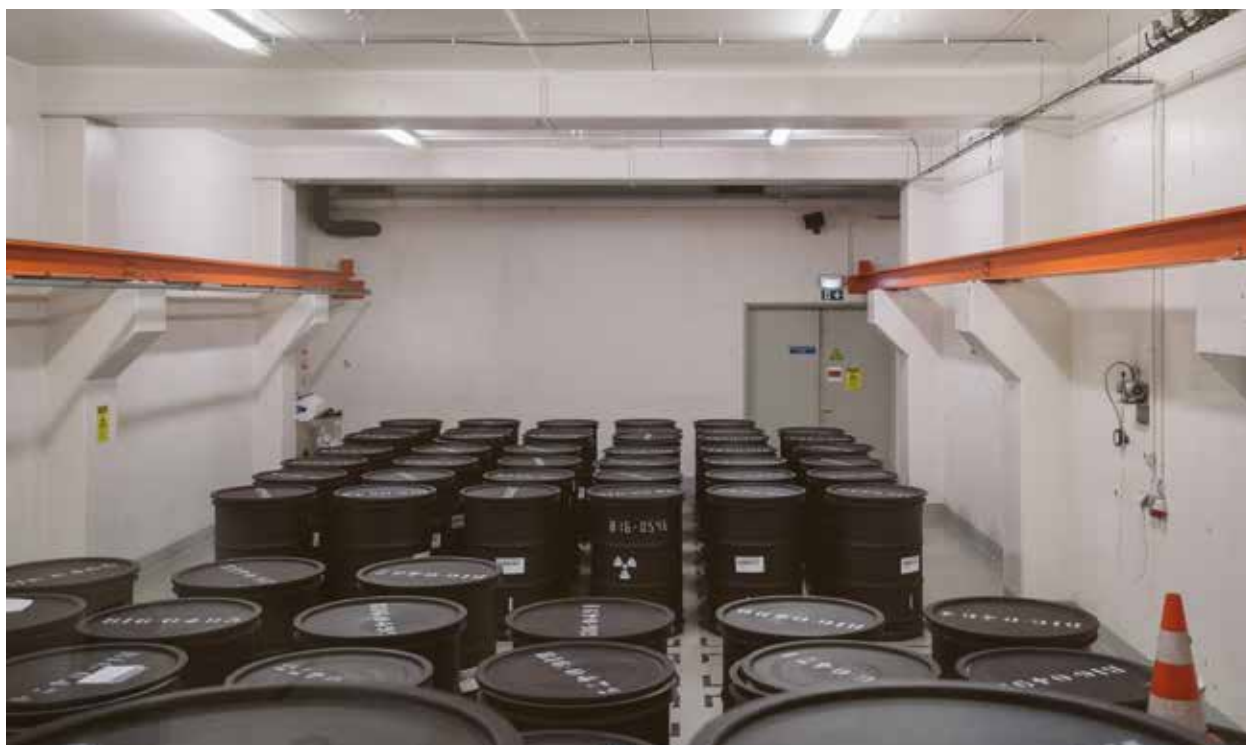
Om het afval te stabiliseren, vullen we de vaten met mortel. Daarna zetten we de vaten in een aparte ruimte, zodat de mortel kan uitharden.
