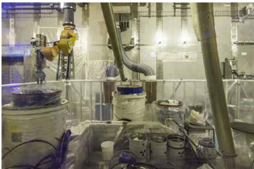
Le tri est réalisé, à l'aide de manipulateurs commandés à distance.
