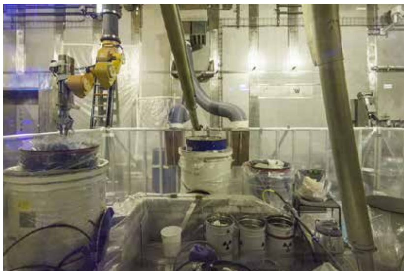
De sortering gebeurt met manipulators die vanop afstand bediend worden.
