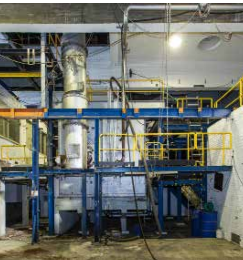
Ontmanteling van de Evence-Coppée-oven die tot midden de jaren 90 ingezet werd voor de verbranding van vaste en vloeibare radioactieve afvalstoffen (links: voor ontmanteling en rechts: na ontmanteling).
