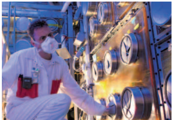
Handschoenkast gebruikt bij de fabricage van kernbrandstoffen
