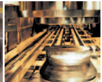
Compactering van hulzen en eindstukken, residu van de opwerking van bestraalde kernbrandstof
