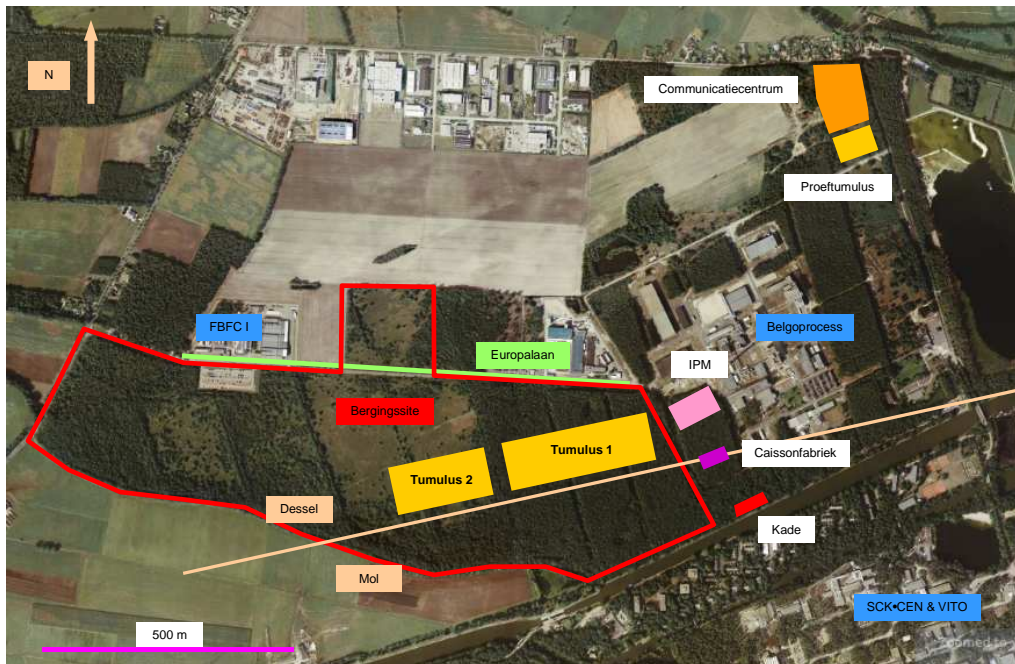
Figuur 3 – Inrichtingsplan van de voornaamste componenten van de berging: kade, caissonfabriek, installatie voor de productie van monolieten en bergingsmodules. Verder wordt ook het communicatiecentrum getoond, alsook de proeftumulus die ernaast zou komen.
