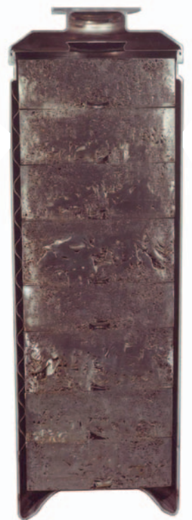
Container met gecompecteerd afval, afkomstig van de opwerking van gebruikte kernbrandstof
