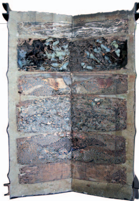
Doorsnede van een vat met laag- of middelactief afval. De samengeperste 200-liter vaten zijn zichtbaar.
