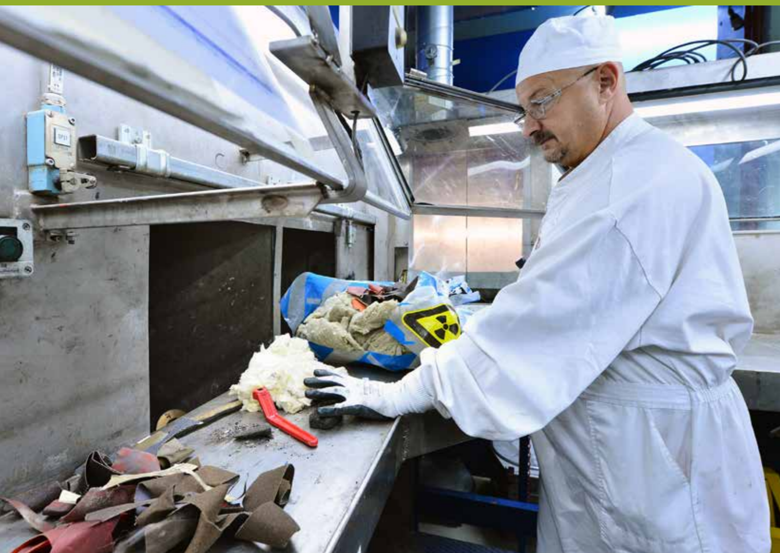
Verwerking van laagactief persbaar afval (kerncentrale van Tihange, eenheid 2).
