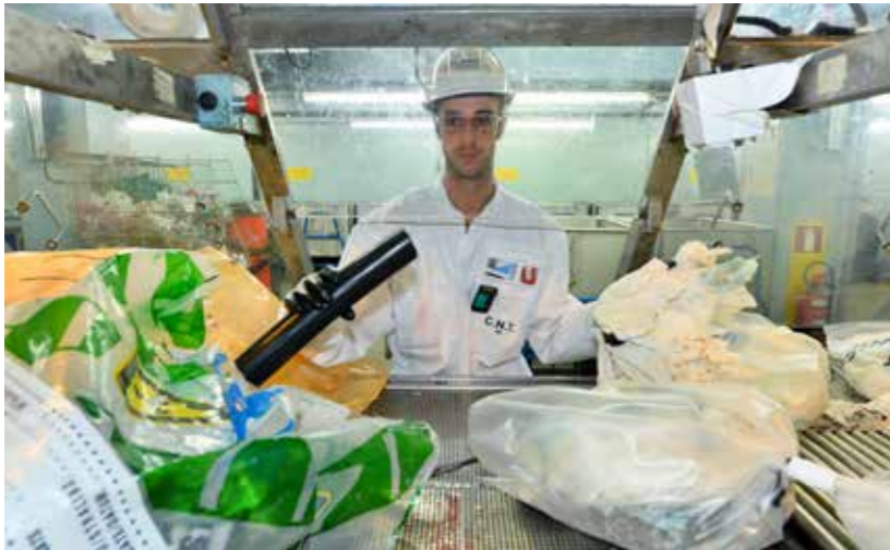
Sortering vóór het vermalen en samenpersen van laagactief brandbaar afval (kerncentrale van Tihange, eenheid 2).
