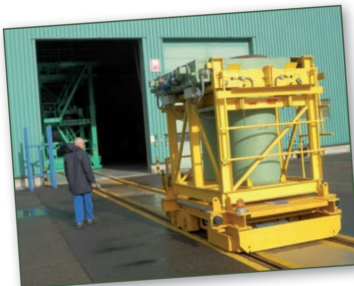
Transfert des canisters entreposés dans le bâtiment 129 vers la cellule de déchargement du bâtiment 136 pour contrôle
